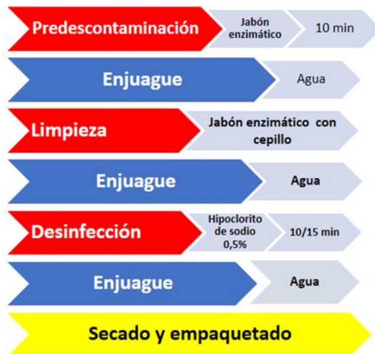
Fig. 2: Procesamiento de material recuperable (PMR)
